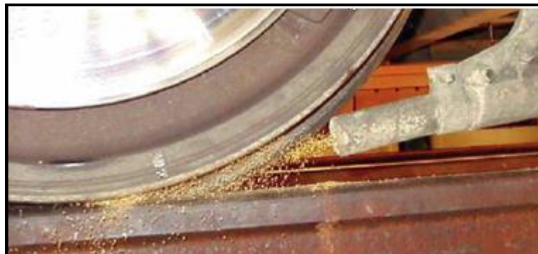
Figura 95: Aplicação de areia, enrijecedor de tração.
