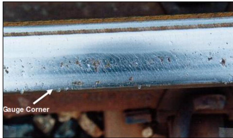
Figura 40: Exemplo de flaking.
