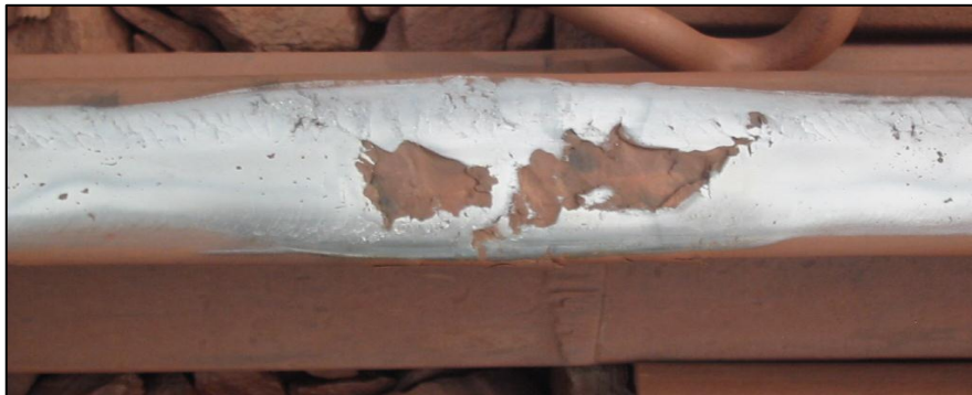
Figura 55: Severo squat em solda flash-butt.
