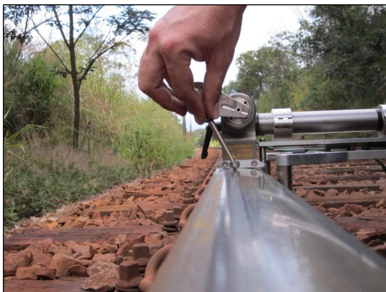
Figura 126: Medição do perfil do trilho com Miniprof.
