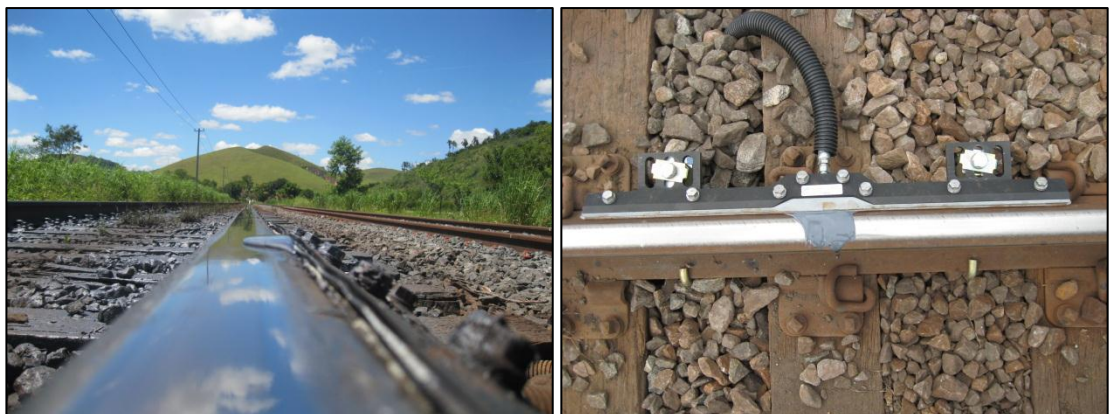
Figura 121: Barra aplicadora de modificador de atrito LBFoster TOR-ML.
