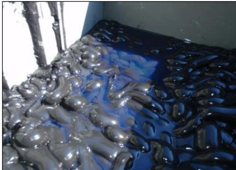
Figura 87: Separação de óleo da graxa no reservatório.
