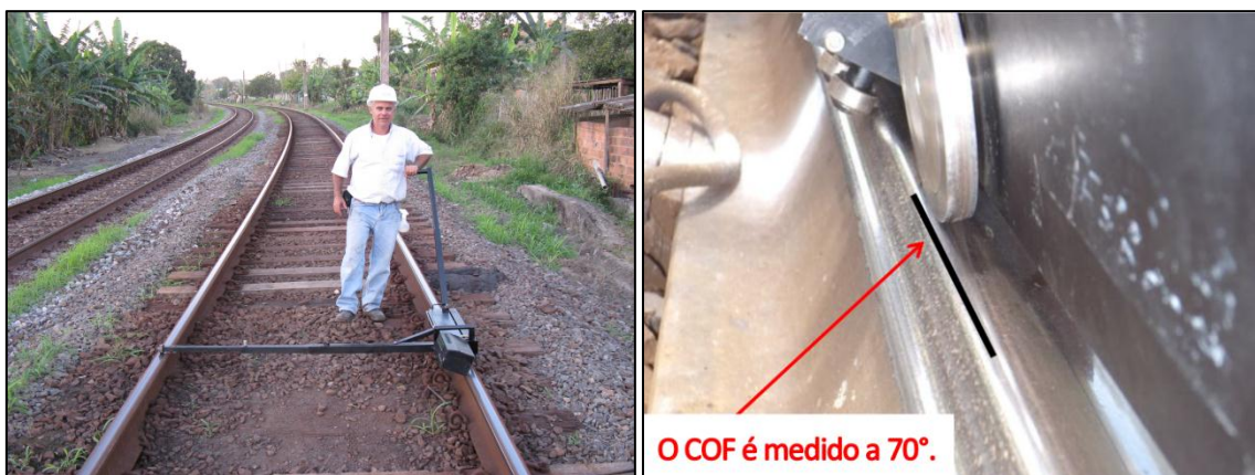
Figura 123: Tribômetro portátil à esquerda, posição onde é medido o COF à direita.
