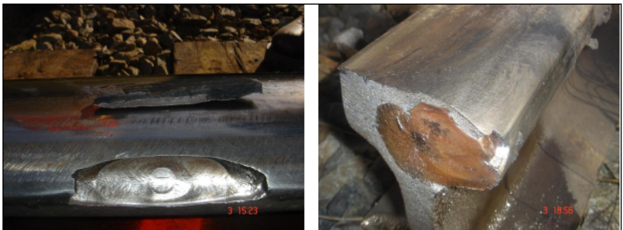
Figura 111: Defeito sub-superficial, DSS - Deep Seated Shell, com formação de fratura transversal no trilho. (SROBA, RONEY, MAGEL, & KALOUSEK, 2007)
