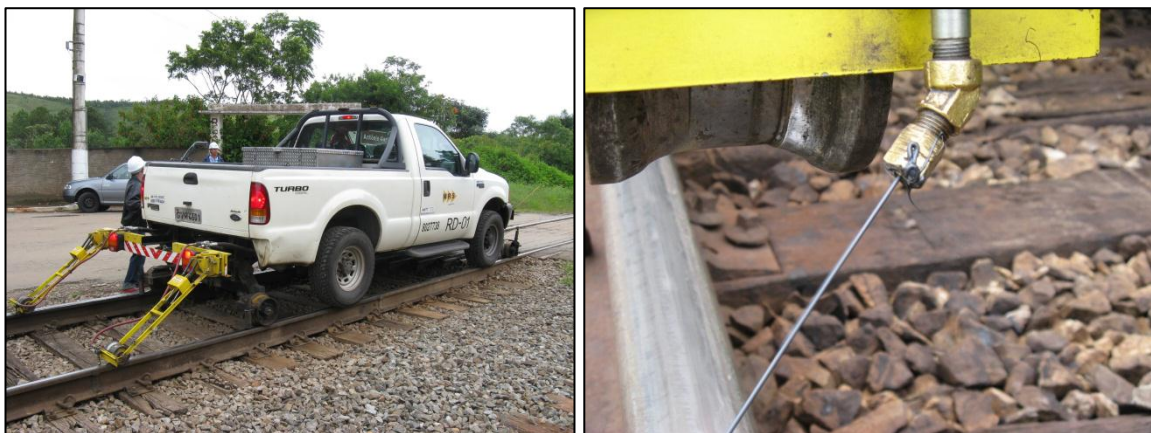
Figura 102: Aplicação de graxa a partir de um veículo rodoferroviário.
