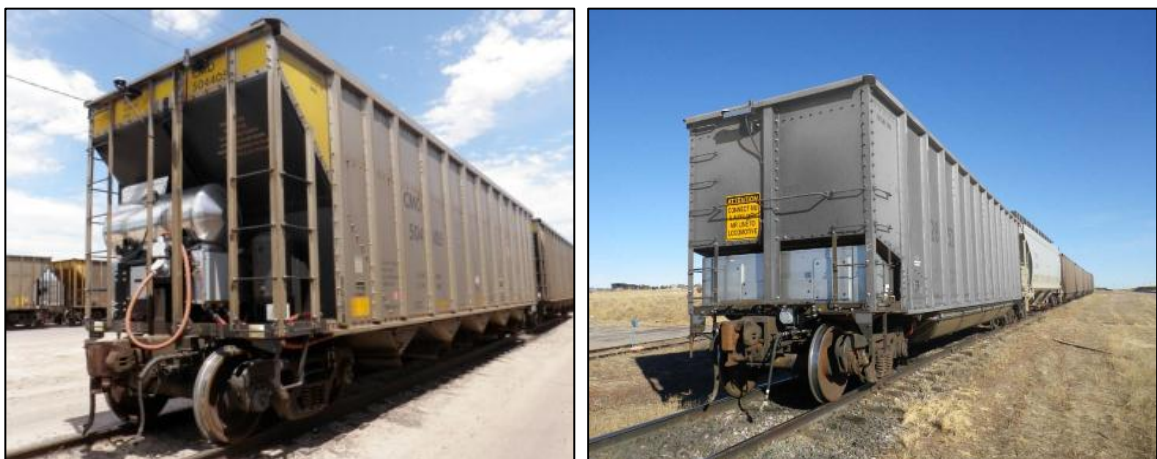
Figura 118: Sistema de aplicação no topo do trilho montado em vagão.
