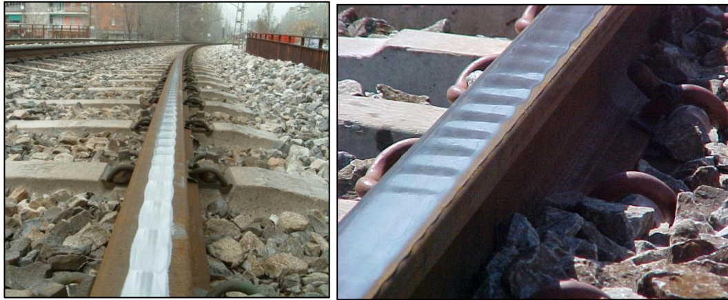
Figura 57: Corrugação “Short Pitch” típica em linha de trem metropolitano.
