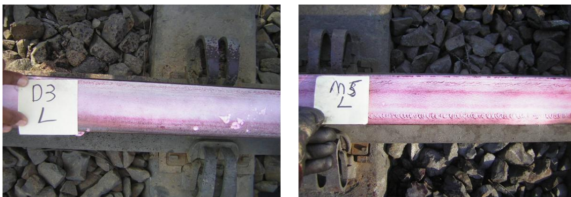
Figura 131: Ensaio de líquido penetrante: à esquerda trilho com controle do atrito no topo, e a direita trilho sem o controle do atrito.
