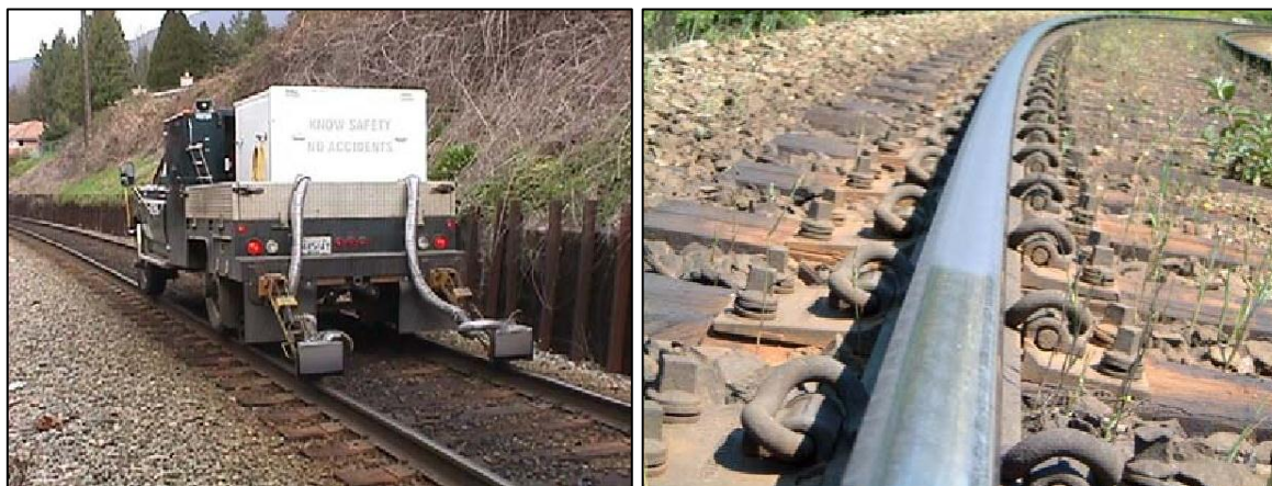
Figura 119: Aplicação de modificador de atrito via veículo rodoferroviário.
