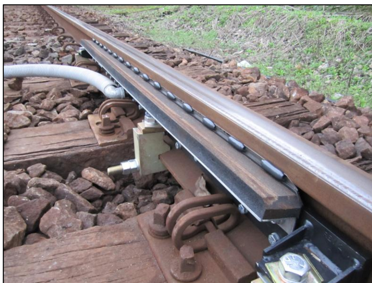
Figura 107: Barras aplicador Portec/LBFoster MC4-XL com 16 portas e guia de graxas.
