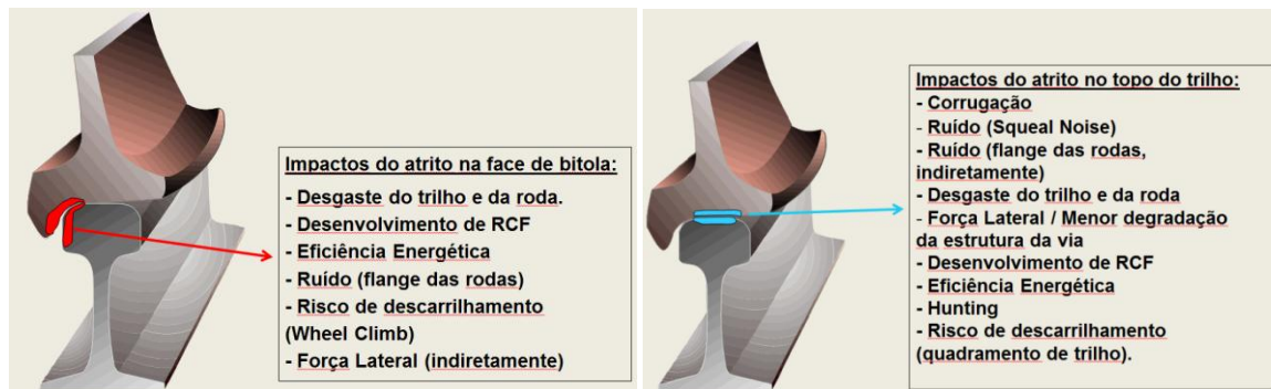
Figura 68: Benefícios do gerenciamento do atrito na face de bitola. (EADIE D. , 2010)
